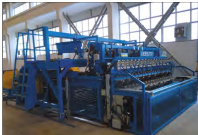
Для производства стандартных арматурных сеток на каждый из трех модернизированных заводов было поставлено по одной установке для сварки арматурной сетки типа Versity. Для производства скоб, хомутов и прутьев было установлено еще девять машин
