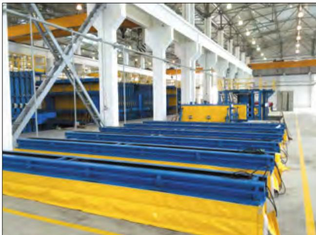
С помощью 15 дополнительных форм обеспечивается производство ригелей (на переднем плане), лестничных маршей (в центре) и вентиляционных шахт (на заднем плане). Интегрированная система обогрева ускоряет процесс отверждения бетона
