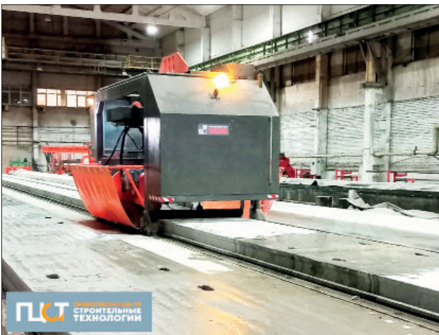
«ПЦ СТ». Линия ЛБФ «Лента» на производстве ЖБИ
