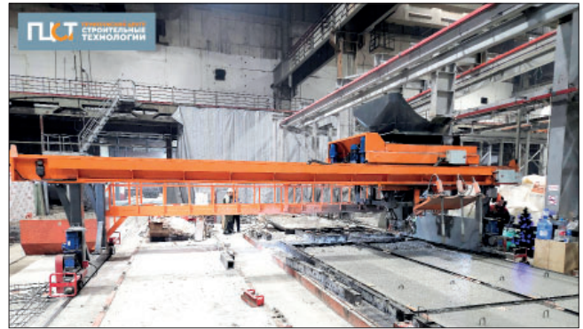
«ПЦ СТ». Вибробетонукладчик ВБУ и кубель БТНВ на производстве ЖБИ
