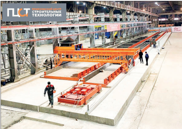
«ПЦ СТ». Современные термостенды на производстве ЖБИ
