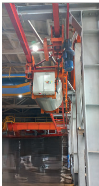
ПЦ СТ адресная подача смеси кубелем БТНВ www.pc-st.ru
