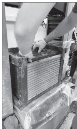
Рис. 9. Процесс подготовки к испытанию под действием давления бетонной смеси (на примере испытания единичного прямоугольного элемента)
