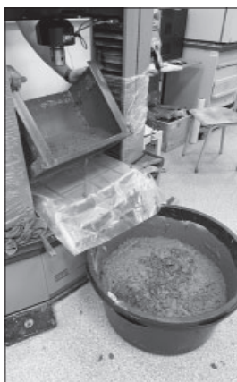
Рис. 9. Процесс подготовки к испытанию под действием давления бетонной смеси (на примере испытания единичного прямоугольного элемента)
