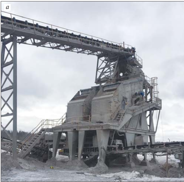
Рис. 3. Грохоты производства НПК «Механобр-техника» в составе установки Telsmith (США) на предприятии «Гранит-Кузнечное»: а – ГИС-54; б – ГИТ-72
