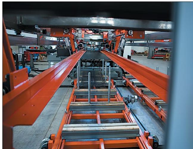
Важно обратить внимание на еще одну особенность этого сварочного центра – возможность сварки двух независимых каркасов как с разными продольными диаметрами арматуры, так и с разными диаметрами поперечной арматуры, если подача поперечных прутков осуществляется с разных бухторазмотчиков, при которых каждый из двух сваренных каркасов получает проволоку из своего бухторазмотчика.
