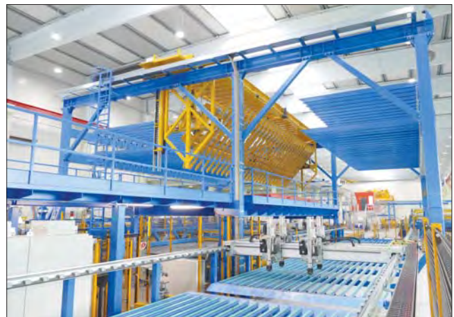
Магнитная траверса укладывает сетки на паллеты в соответствии с данными САПР, обслуживает накопитель промежуточного хранения, может поворачивать сетки, если продольные прутки должны располагаться над поперечными прутками, и укладывает сетки на штабельную вагонетку The magnetic traverse stacks the nets on pallets in accordance with CAD data, maintains an intermediate storage drive, can rotate the nets if the longitudinal bars are to be located above transverse rods, and places the nets on the stacking car
