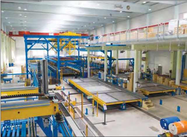
Новая высокоавтоматизированная линия циркуляции паллет на заводе EDER в г. Калльхаме New highly automated pallet circulation line at the EDER plant in Kallham
