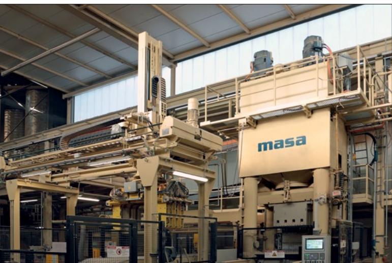
Модернизированный пресс фирмы Masa HDP 1200 J для изготовления силикатных изделий, оснащенный сервогидравлическим приводом Simotics M-1PH8. Установлен на голландском предприятии, изготавливает крупноформатные строительные элементы стабильно высокого качества при значительно сниженном энергопотреблении
