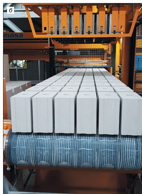
Рис. 2. Прессы HDP 800, установленные на заводе под Варшавой (Польша) (а) и свежесформованные силикатные блоки (б)
