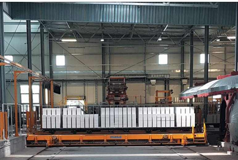
Рис. 5. Трансбордер. Подача изделий в автоклавы
