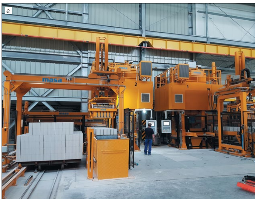
Рис. 2. Прессы HDP 800, установленные на заводе под Варшавой (Польша) (а) и свежесформованные силикатные блоки (б)
