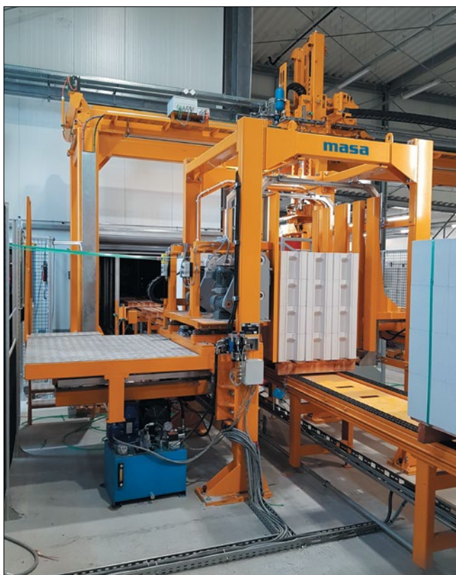
Рис. 7. Обвязка готовых силикатных блоков
