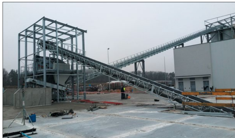
Рис. 4. Система подачи сырья
