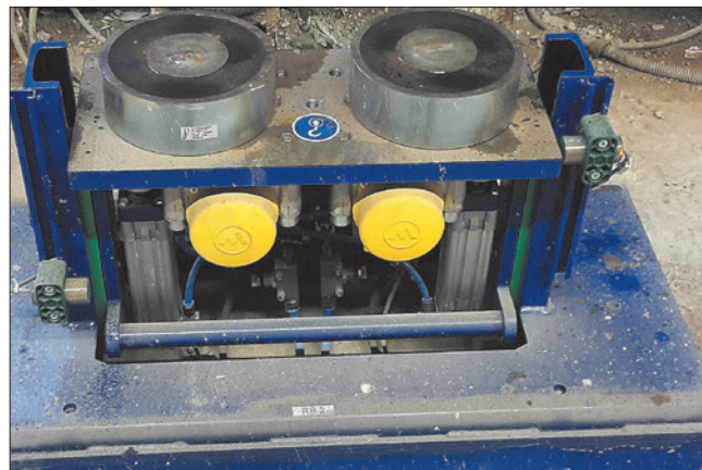
MagVib – высокочастотный вибрационный блок (синего цвета), на заднем плане – старая вибрационная рама
