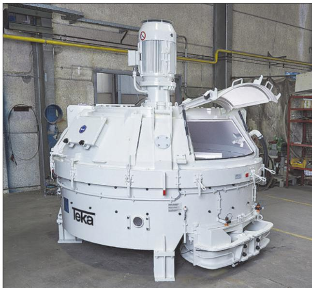
Турбинный смеситель ТЕКА на производстве
