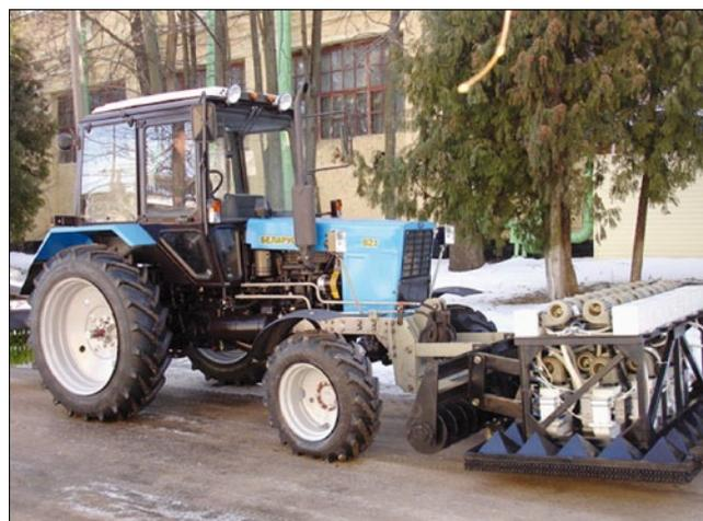
**Рис. 2.** Опытная мобильная установка с СВЧ-нагревателями для прогрева горизонтальной поверхности. Техническая характеристика: потребляемая мощность 30 кВт; мощность СВЧ-излучателя 20 кВт; частота излучения 2450 МГц; площадь излучателя 1,5–1 м<sup>2</sup>
